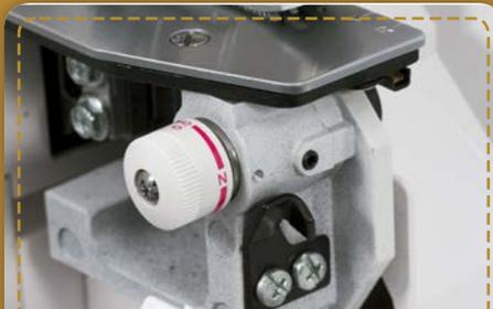
**Schnittbreitenverstellung:** Breitere oder schmalere Nähte? Hierzu einfach die Schnittbreitenverstellung verwenden, eine Skala hilft Ihnen dabei, die richtige Schnittbreite zu finden.
