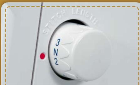
**Stichlängenverstellung:** Längere oder kürzere Stiche, einfach die Stichlänge stufenlos zwischen 1 mm und 4 mm einstellen. Benutzen Sie einfach die außen befindlichen Bedienelemente dazu.
